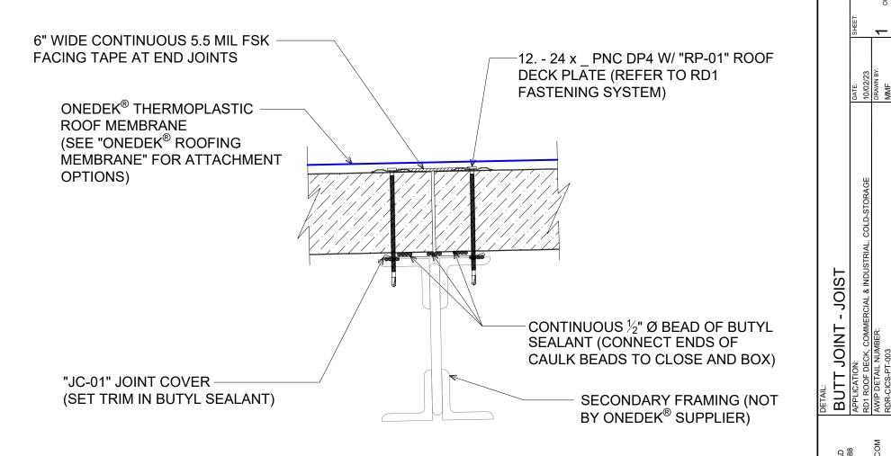
**#** BUTT JOINT DETAIL - JOIST
