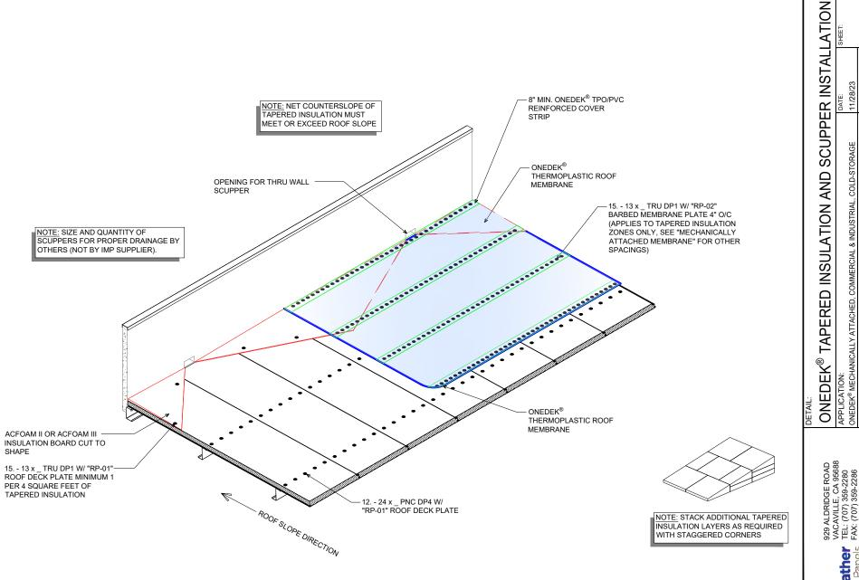
ONEDEK® TAPERED INSULATION AND SCUPPER INSTALLATION ALONG PARAPET (MECHANICALLY ATTACHED)
